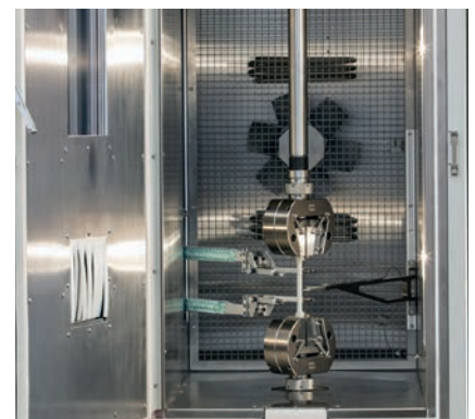
Bild 4: Temperierkammern können ebenfalls nachgerüstet werden
