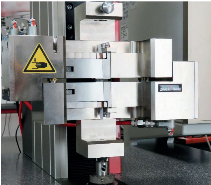
Bild 1: Streifenstauchwiderstand einer S-förmig eingespannten Probe (S-Test)
