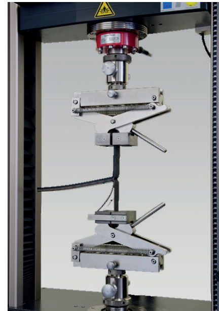
Bild 2: Trennversuch zur Bestimmung der Lagenhaftung der Schichten
